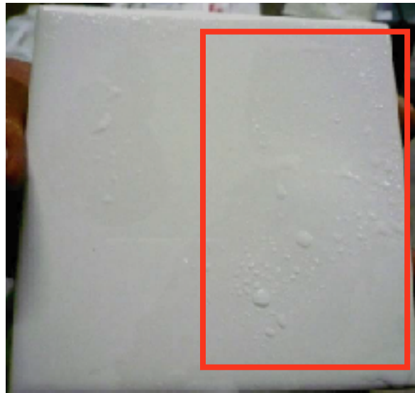
塗布部分の 撥水状態
